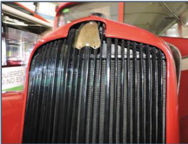
*Detalle entre el capo y el grueso del autobus separado por lona, para evitar que las vibraciones se transmiten a la carrocería, provocando fisuras.*
