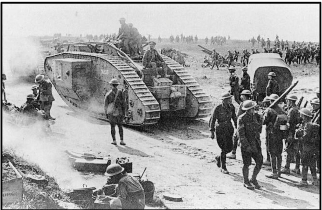
F-5 Carro de combate inglés Mark V, equipado con el motor Ricardo de 150 CV
