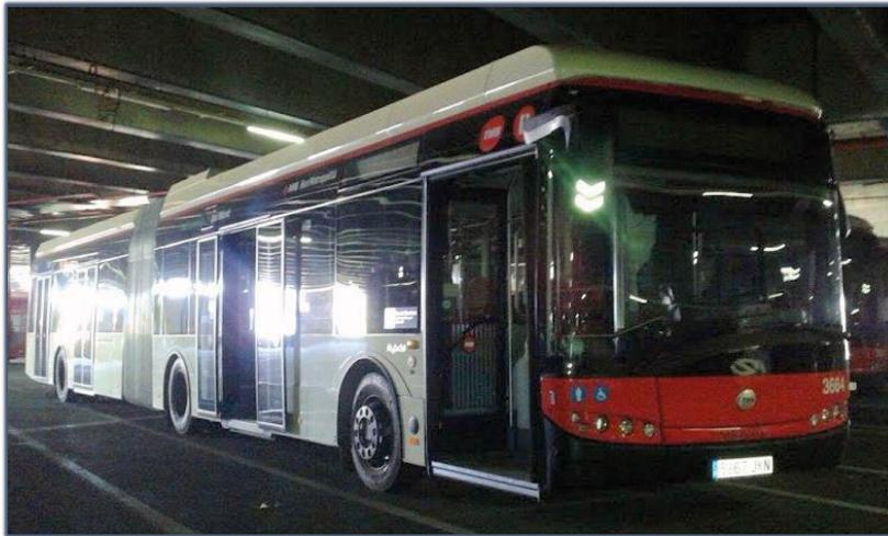
*La última adquisición de prueba. El Solaris Polonez. Autonomía de 20 kilómetros y a través de un pantógrafo, recibe un chute eléctrico, para recorrer los siguientes veinte. Eléctrico total.*
