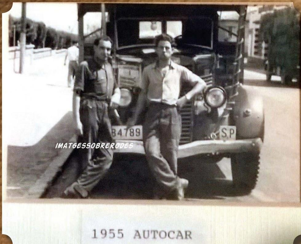
Otro camión adquirida por los Hermanos Balsells, fué un DE SOTO, continuando con los vehiculos americanos Hasta el momento. Este camión estaba fabricación por una rama de Chrysler, en la cual empleo el mejor de super ingenieria, equipaba un motor Plymouth de 6 cilindros, una maravilla de la época. Chrysler tambien fabricaba segun el Pais, los Dodge y Fargo. La carrocería, como las anteriores, la construyo Sucarrats de Cervera.
