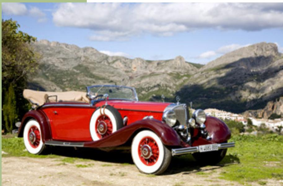
► **Modelo:** Mercedes-Benz 500 K (W29) Cabriolet B de 1934. **Motor:** 8 cilindros en línea. **Cilindrada:** 5.018 cc. **Potencia:** 100 CV a 3.400 rpm; 160 CV cuando actúa el compresor. **Velocidad máxima:** unos 160 km/h. **Peso:** 2.300 kg.
