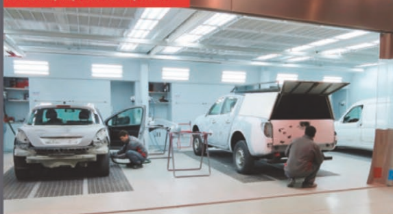
zona de preparació de pintura
