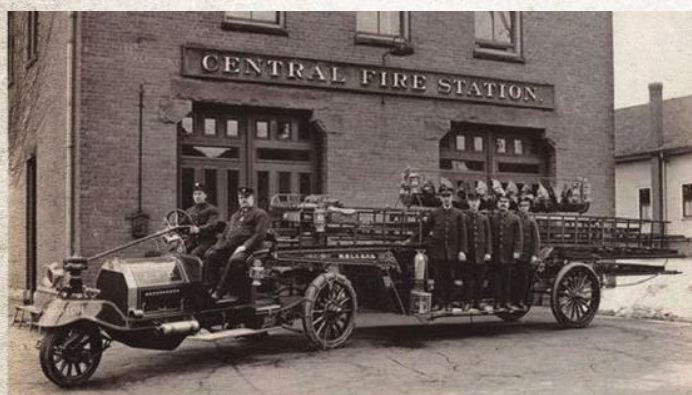
Dos exemples de com substituir l'eix direccional del carro per una tractora els EUA
