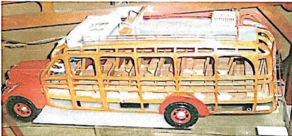
Maqueta del Museu d'Arbúcies que mostra la carrosseria de fusta d'un Òmnibus
