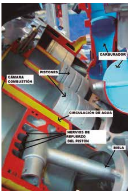
Motor Hispano-Suiza V8 seccionado, las zonas en amarillo son las de circulación del agua de refrigeración. (Museo del Aire Portugués, Alverca).
